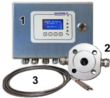
*Kemtrak DCP007 Prozeßphotometer (1) mit DIN DN25 Messzelle (2) und optischen Lichtleiterkabeln (3)*
