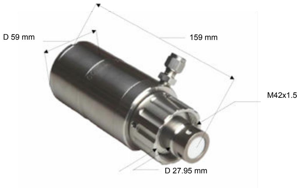
Der Sensor arbeitet nach dem folgenden Prinzip: Das zu messende Gas diffundiert aus der Probe über eine halbdurchlässige Membrane in den Innenraum des Sensors und kommt dort in Kontakt mit dem Wärmeleitfähigkeitsdetektor. Die Temperatur und die Änderung der Wärmeleitfähigkeit durch das Messgas werden gemessen.
